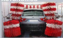
En instalaciones a partir de 12,5 metros, se pueden instalar dos cepillos verticales adicionales para ofrecer un valor añadido a la instalación y una mayor calidad de lavado.
