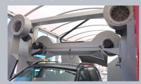
El módulo de secado está compuesto de 4 turboventiladores con una potencia de 4 Kw cada uno, trabajando a bajas revoluciones (1500 rpm) y con un alto caudal de aire para mejorar el rendimiento.
