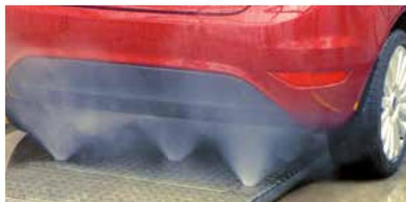
Pode eligir entre lavagem de baixos fixo 10 bar, 90 L/min, oscilante 15 bar, 120 L/min ou por sectores 15 bar, 120 L/min.
