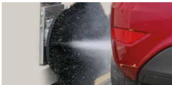
Uma limpeza completa deve incluir as rodas do veículo. Disponível com e sem alta pressão, pode utilizar escovas planas ou em espiral.
