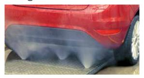
Pode-se escolher entre estas duas opções: uma lavagem de baixos fixa 10 bar. 90 L/ min ou uma lavagem de baixos oscilante 15 bar. 120 L/min
